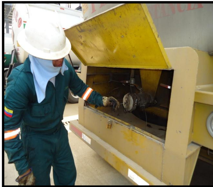
Imagen 17. Revisión y postura de sellos para el despacho del carrotanque.
