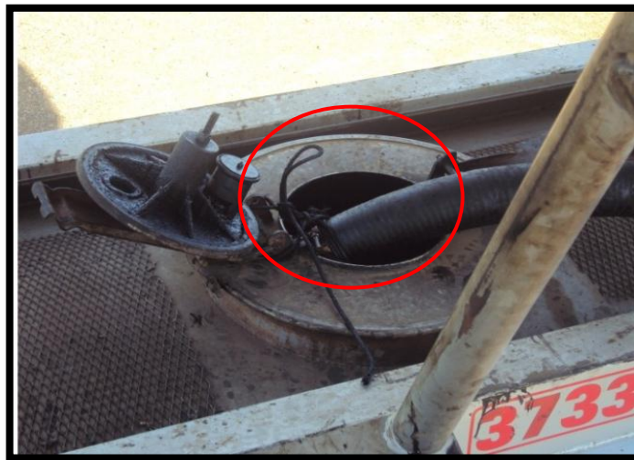
Imagen 20. Manguera asegurada en la escotilla del carrotanque.
