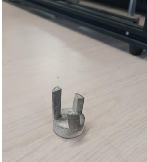
Figura 35 Eje de objeto de estudio después de la falla.
