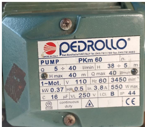
Figura 30 Motor encargado de suministrar potencia al eje objeto de estudio
