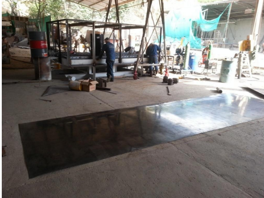
Ilustración 32. Trazado y corte de láminas
