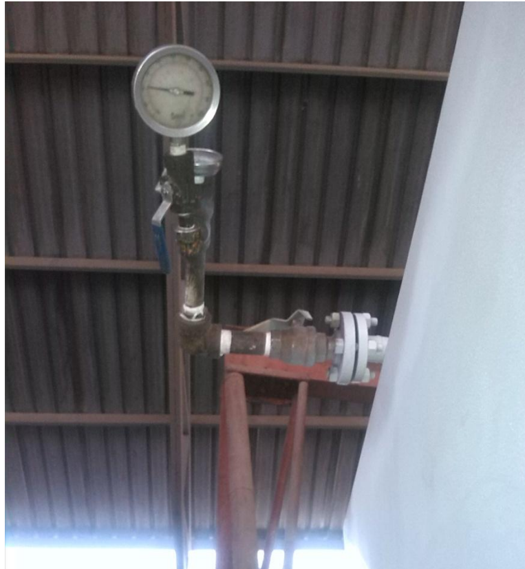
Ilustración 45. Manómetro y termómetro de la prueba hidrostática
