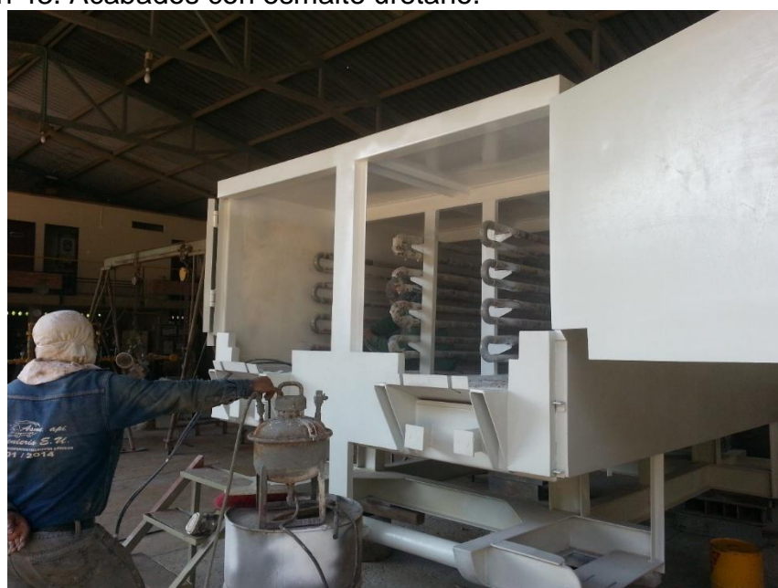
Ilustración 43. Acabados con esmalte uretano.
