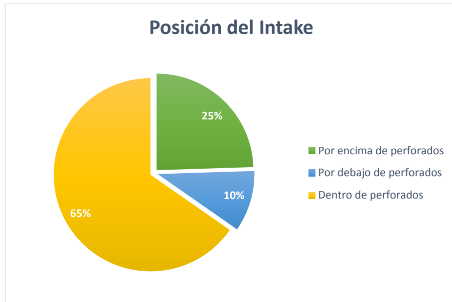
Figura N.26 – Intake de bomba dentro, fuera y bajo perforados.
