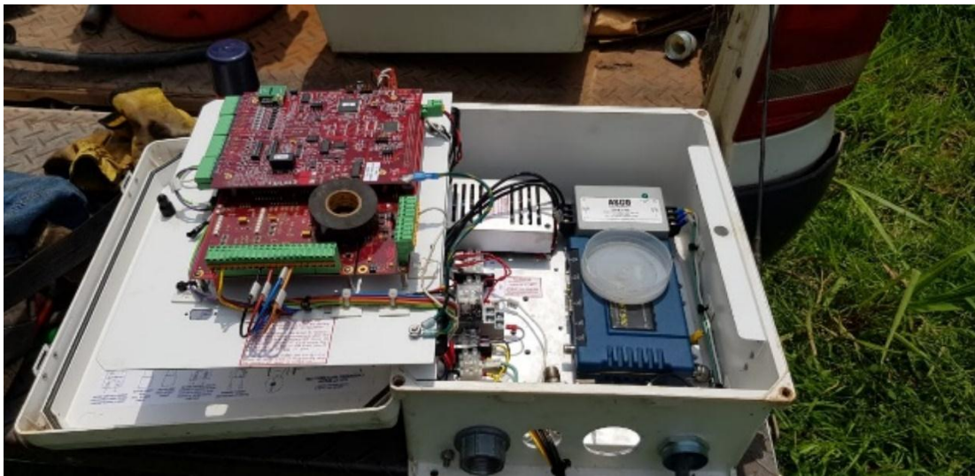
Figura N.5 – Gabinete controlador SAM.
