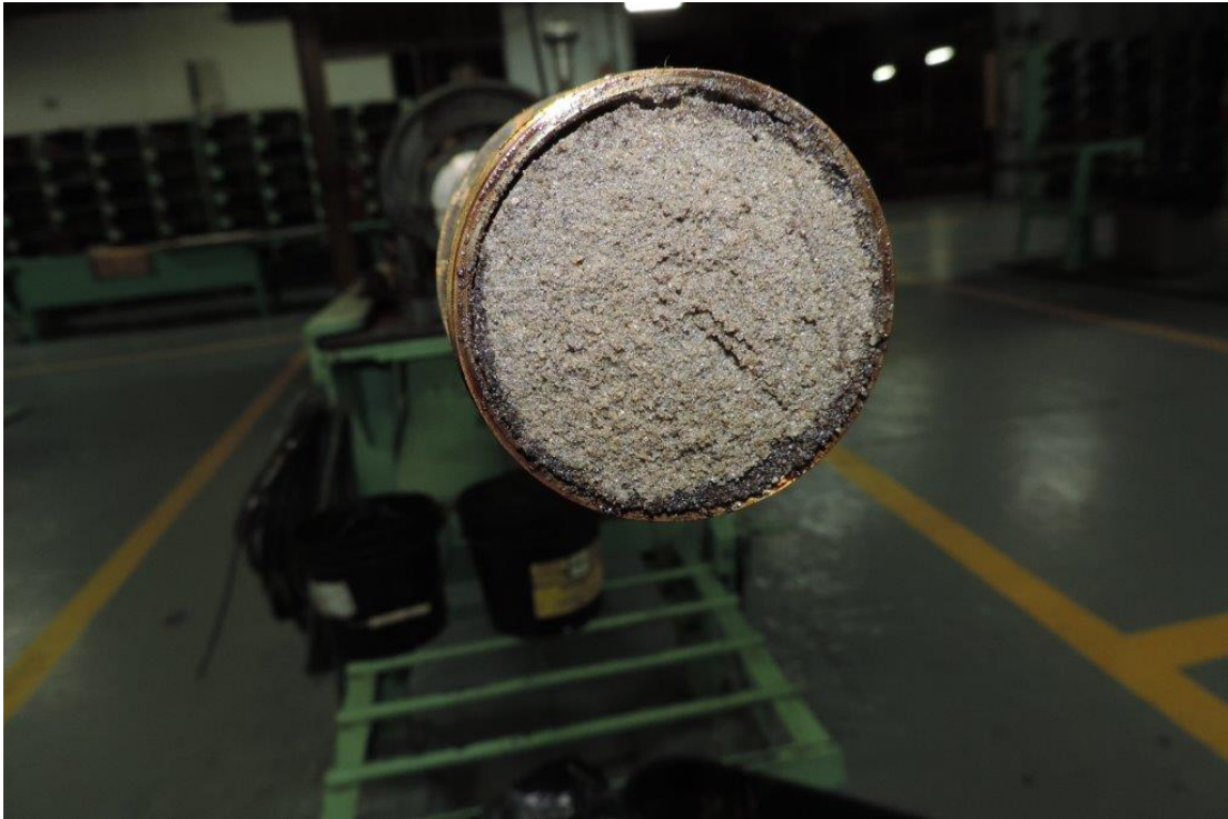
Figura N.18 – Barril bloqueado por arena.
