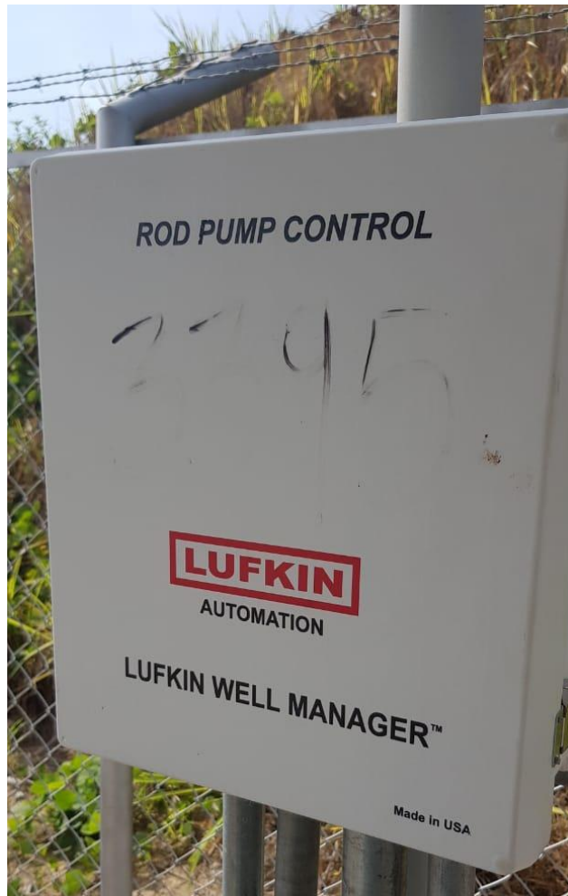
Figura N.6 – Controlador SAM posicionado.
