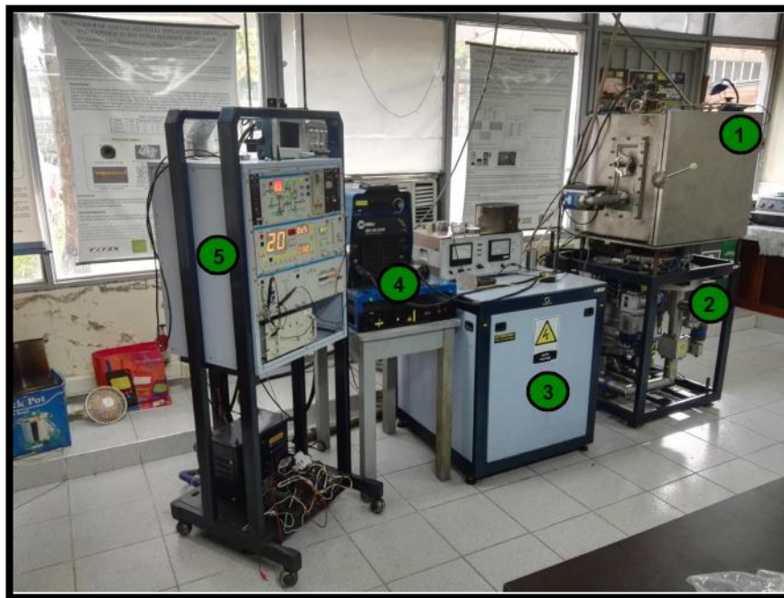
Figura B1. Dispositivo JUPITER (Joint Universal Plasma and Ion Implantation technologies Experimental Reactor) y sus módulos.
