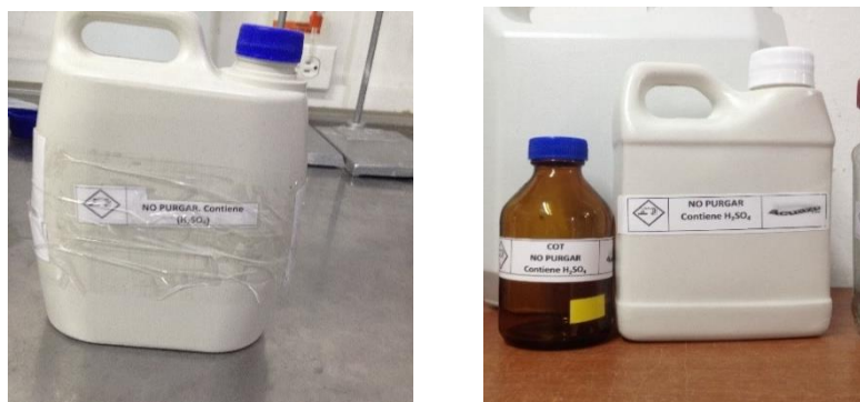
Figura 39: Recipientes con la etiqueta de preservación de muestras. Tomado de: Información suministrada por Acuazul Ltda
