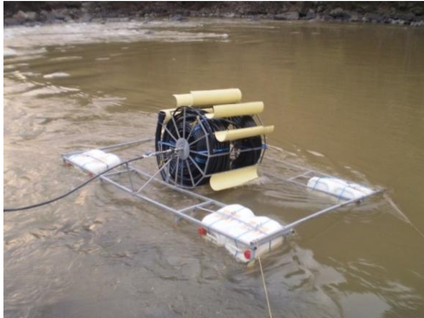
Figura 22. Bomba Rueda instalada en el rio Fonce.
