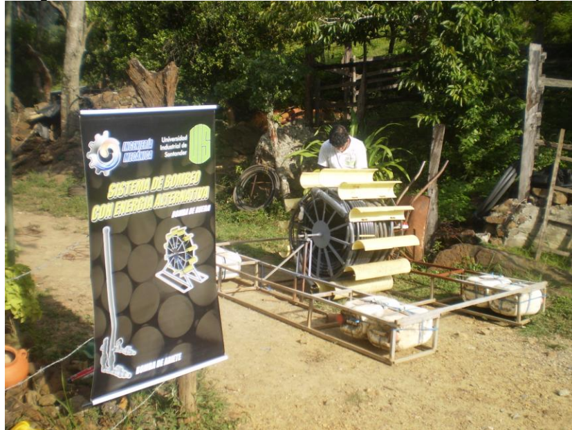
Figura 55. Bomba de rueda instalada en la Vereda Naranjal bajo.
