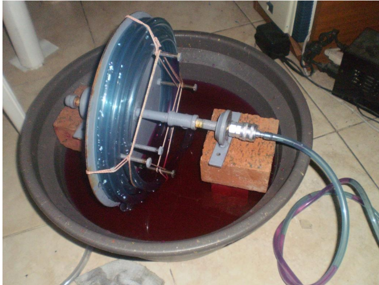
Figura 3. Prototipo de bomba rueda construido, para las pruebas.
