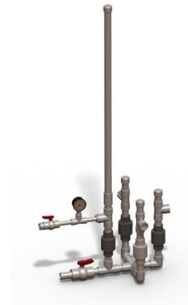
Figura 5b. Modelo de la bomba de rueda utilizada para las pruebas con 3,2 y 1 colectores e instalada en la vereda Naranjal Bajo.
