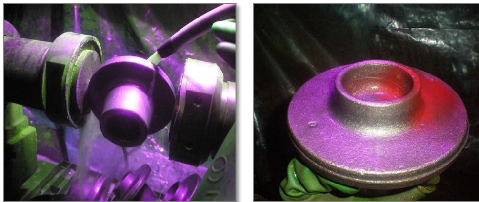
Ilustración 8. Rocío de Magnagro y verificación de grietas
