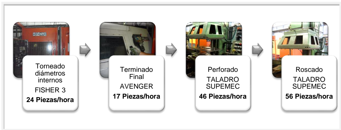
Ilustración 20. Línea Cubo Rueda Mecanizado
