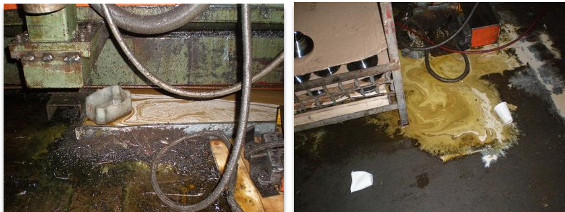
Ilustración 2. Fuga de Taladrina en las máquinas
