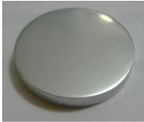
Figura 12. Apariencia superficial de una probeta de la aleación Ti6Al4V después de realizado el pulido químico.
