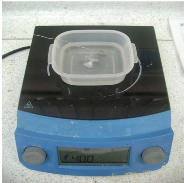
Figura 11. Fotografía del montaje experimental utilizado en el pulido químico de las muestras de la aleación Ti6Al4V
