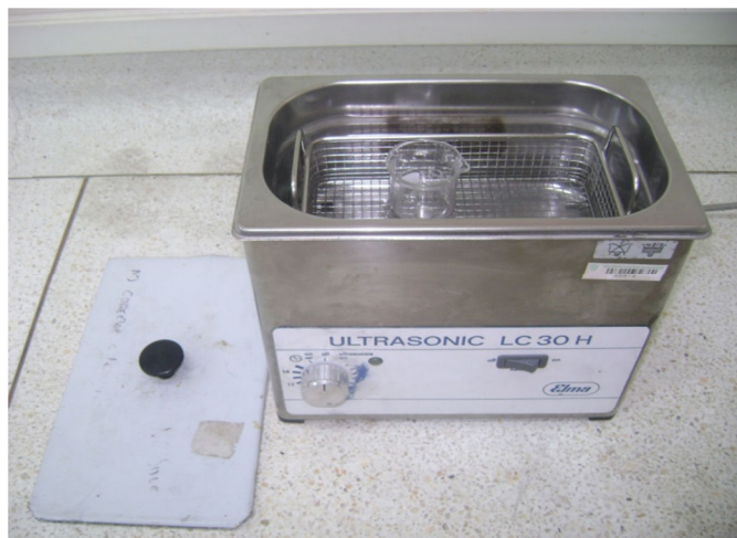
Figura 13. Fotografía del equipo de limpieza ultrasónica usado para la preparación de la muestras de Ti6Al4V.
