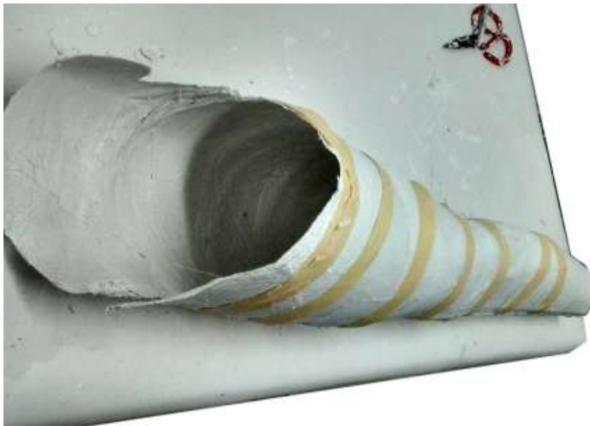
Figura 36. Sellamiento de molde para relleno de yeso
