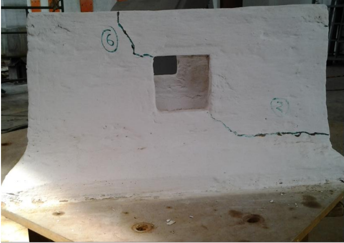
Figura 13. Fallas presentadas en el modelo cuadrado.
