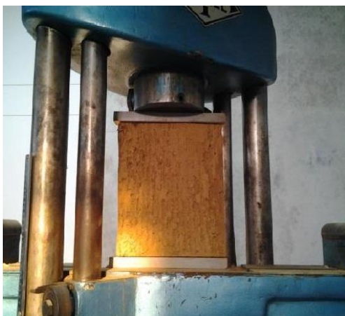
Figura 14. Ensayo de compresión simple y falla presentada en muretes de adobe a escala 1:10.
