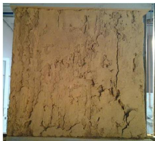
Figura 14. Ensayo de compresión simple y falla presentada en muretes de adobe a escala 1:10.
