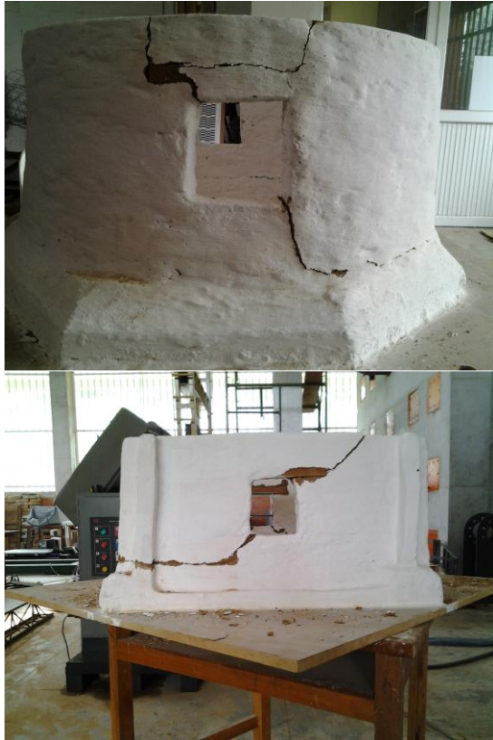
Anexo G. Fallas presentadas en el modelo circular y de muros convexos con contrafuertes en las esquinas.
