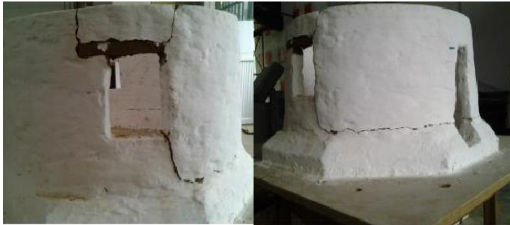
Figura 10. Fallas presentadas en el modelo circular.
