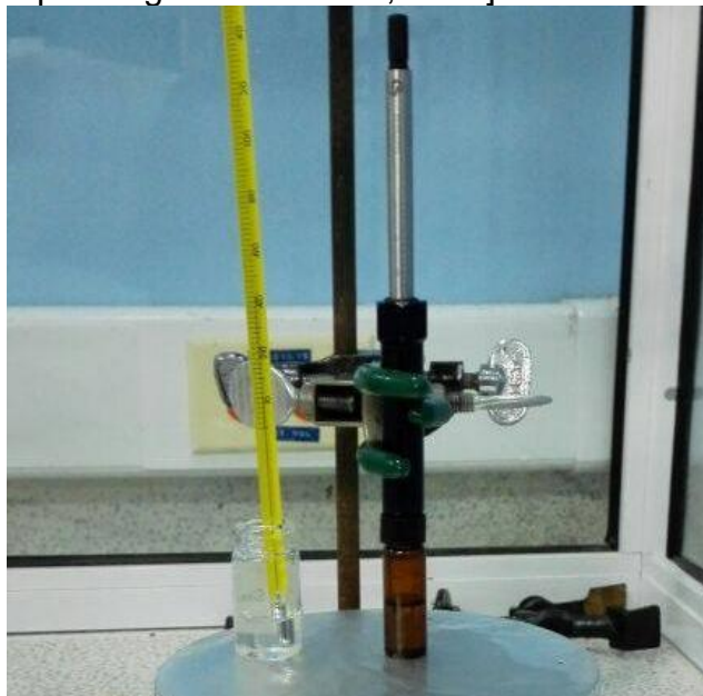
Figura 20. Montaje usado en el monitoreo de fracción volátil de extractos SFE por HS-SPME. [Tomada por Rogerio Saavedra, 2014]
