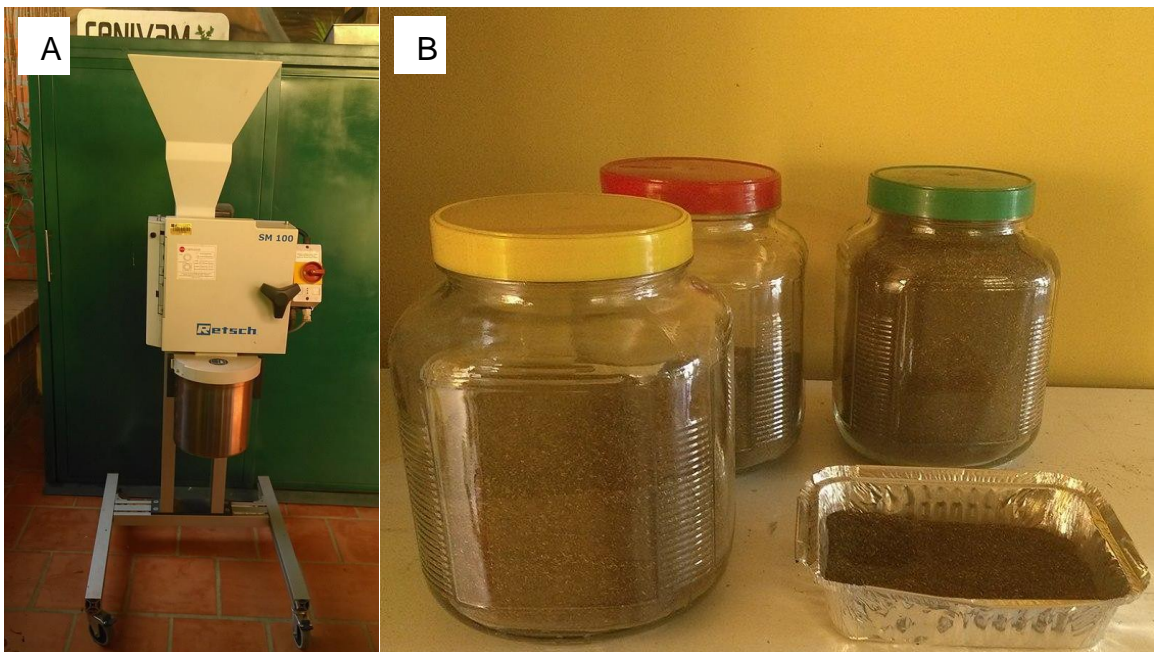
Figura 17. A) Molino de cuchillas Retsch SM100neu. B) Material vegetal seco y picado. [Tomada por Rogerio Saavedra, 2014]
