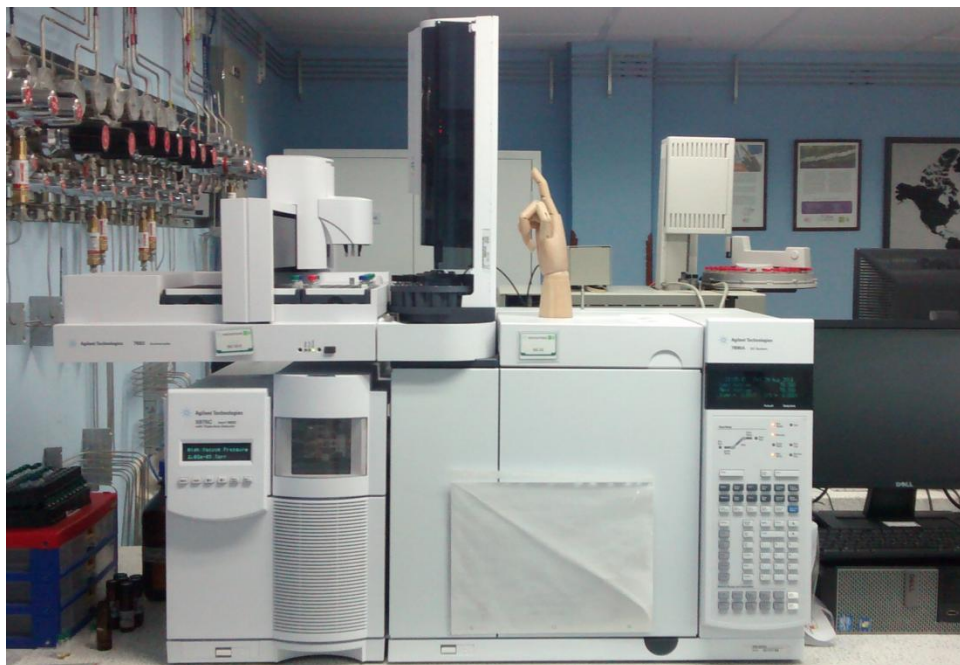
Figura 19. Cromatógrafo de gases GC Agilent Technologies 6890 Plus acoplado a un espectrómetro de masas Agilent Technologies MSD 5973 Network. [Tomada por Rogerio Saavedra, 2014]
