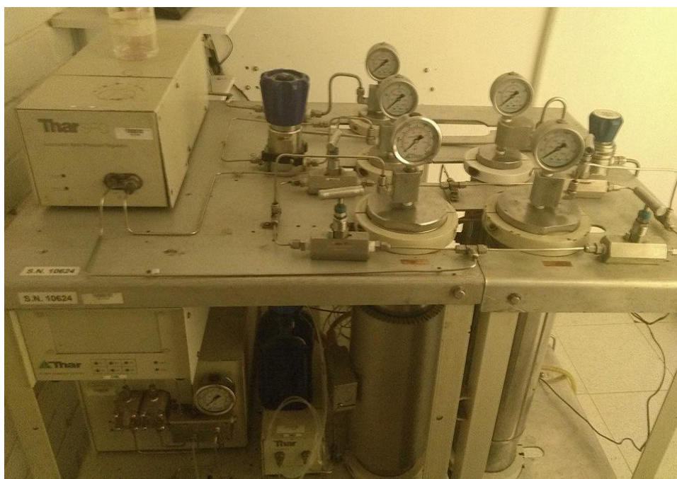
Figura 18. Equipo de extracción con fluidos supercríticos Thar SFE-200-2-FMC50. [Tomada por Rogerio Saavedra, 2014]
