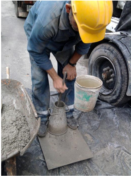
Figura 16. Compactación primera capa
