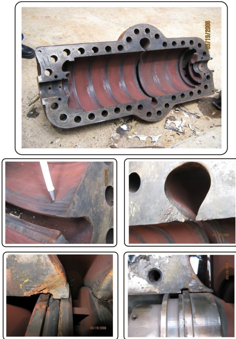
Figura 11. Patrón de erosión y daño en anillos de desgaste presentado en falla de la SPP1C
