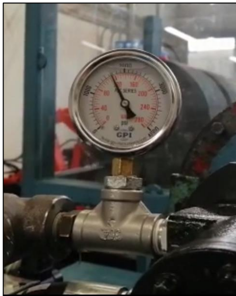
Figura 65. Presión al arranque (captura durante ensayo)
