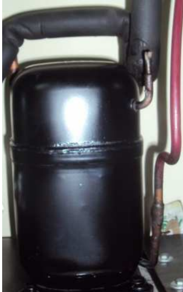
Figura 17. Unidad compresora utilizada como bomba de vacío.
