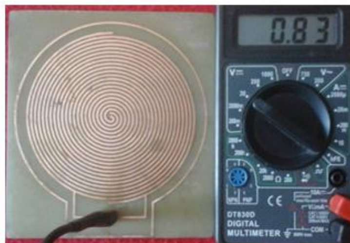
Figura No. 22. Nivel de voltaje Electrodo “ESPIRAL”
