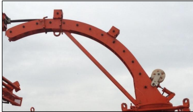
Figura 3. Foto De Un Típico Arco Guía De Tubería También Conocido Como Cuello De Ganso (Gooseneck).
