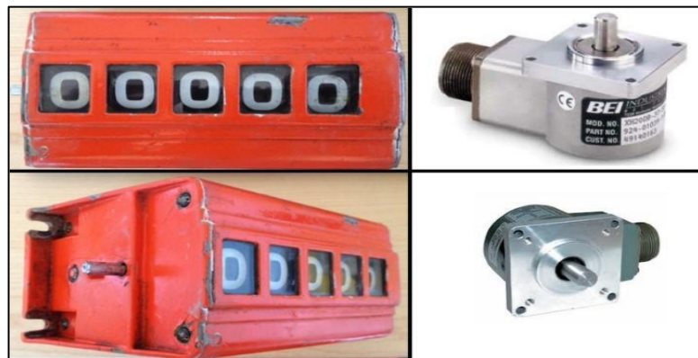
Figura 5. Contador De Profundidad Mecánico (izquierda) Y Electrónico (derecha)
