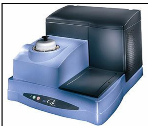
Figura 2.1 Equipo DSC; Marca TA Instruments Modelo Q10
