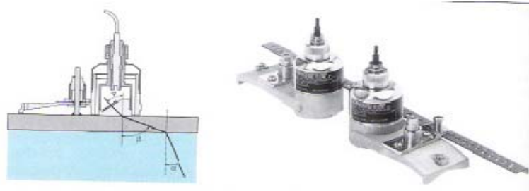
Figura 13. Los sensores de fijación externa se montan directamente en el exterior de la tubería. Un riel especial de montaje facilita su posicionamiento exacto. [1]
