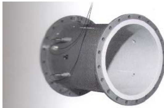
Figura 15. Tubo de medición prefabricado con cuatro sensores de inserción y dos caminos acústicos de medición. [1]
