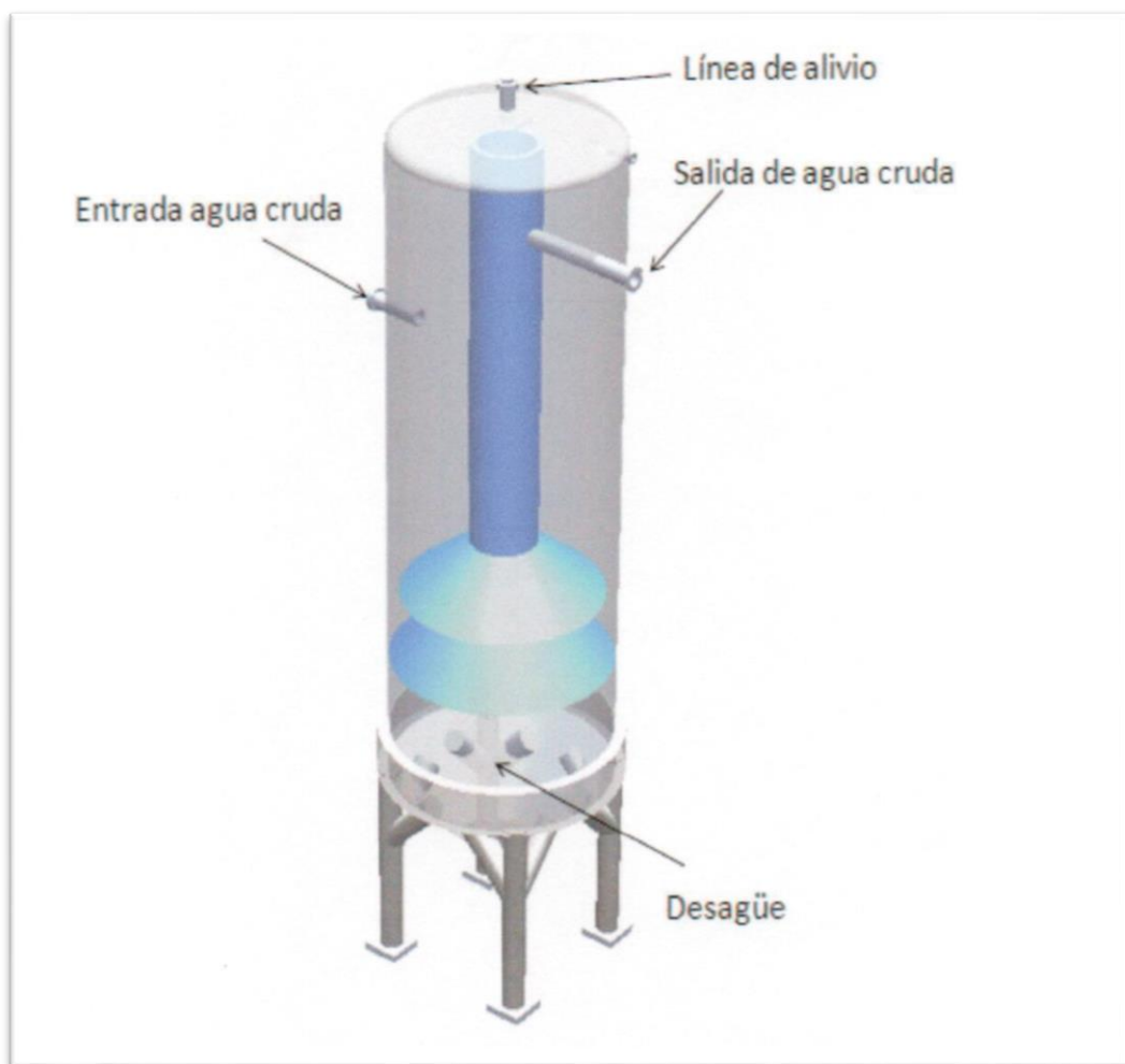
Figura 3. Sistema de Filtración
