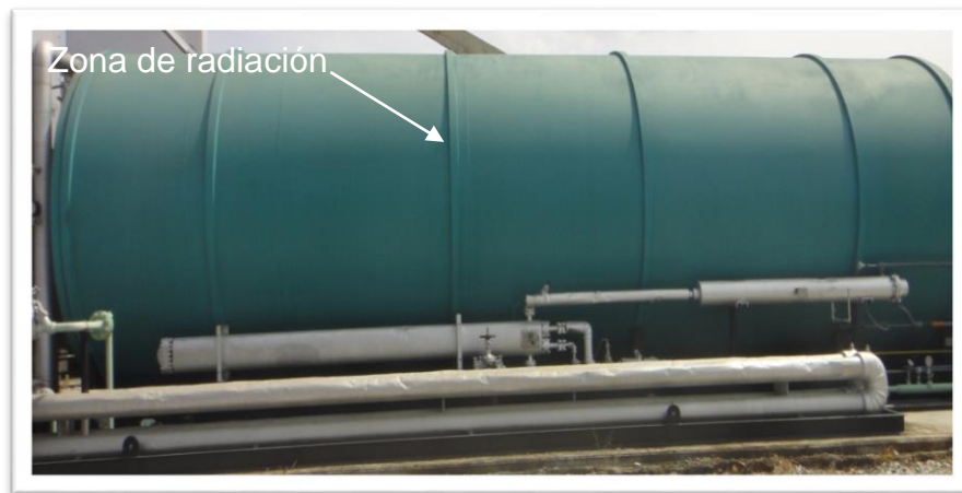
Figura 12. Zona de radiación
