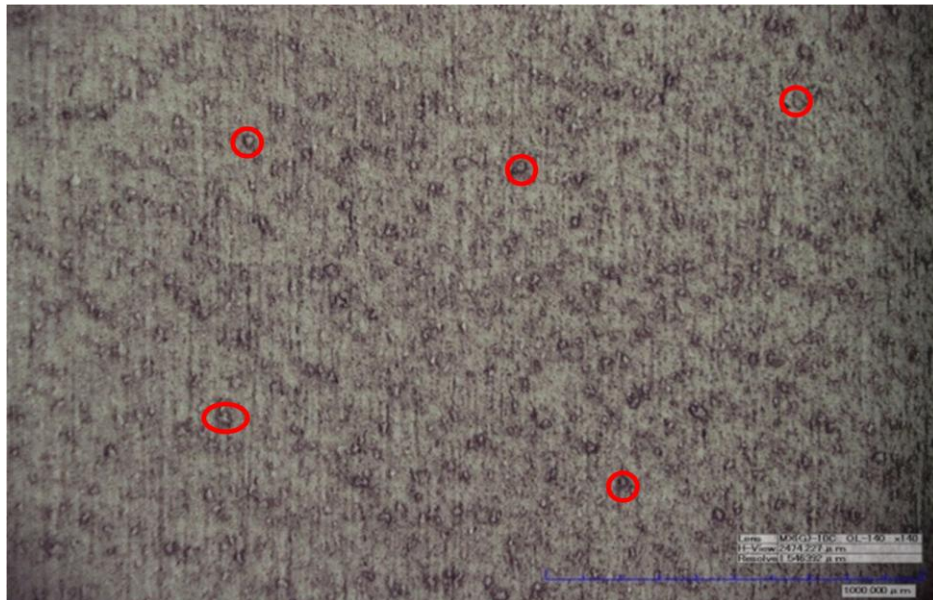
Figura 8. Fotografías probetas en solución simulada de sangre. 140X
