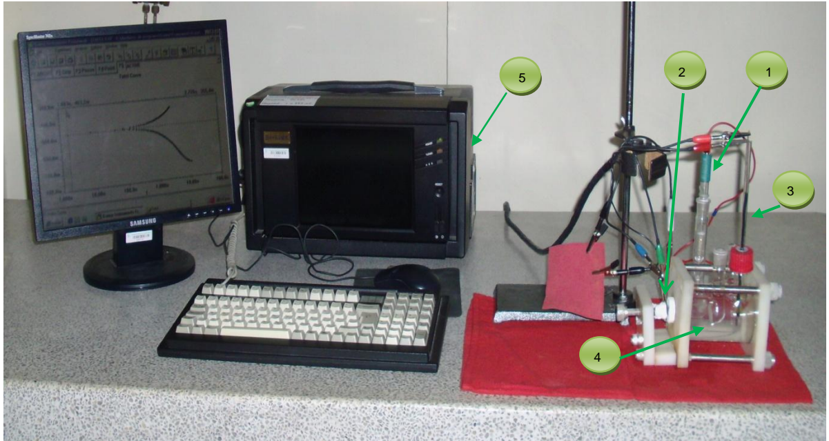
Figura 5. Montaje para pruebas de corrosión
