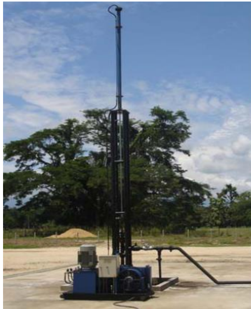
Figura 12. Unidad hidráulica de bombeo REF: A-30-32-120-1.5
