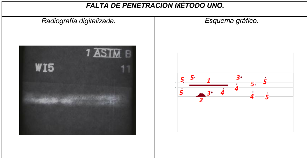
Figura 10. Radiografía digitalizada y esquema gráfico de la defectología de la probeta con falta de penetración generada con el método uno.
