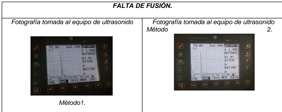
Figura 15. Fotografías tomadas al equipo de ultrasonido cuando se obtuvo la discontinuidad al 80%.
