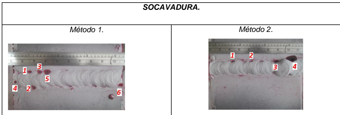
Figura 9. Fotografías del ensayo de líquidos penetrantes aplicado a las probetas con socavadura inducida generadas con el método uno y dos.
