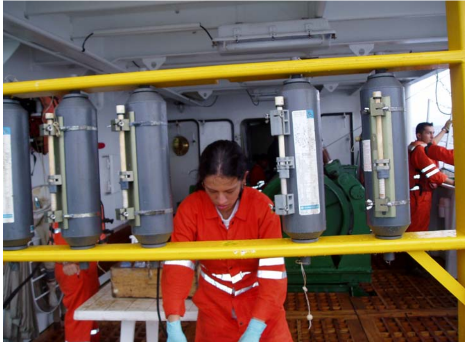
Figura 7. Rack oceanográfico utilizado para asegurar las botellas Niskin durante la navegación.
