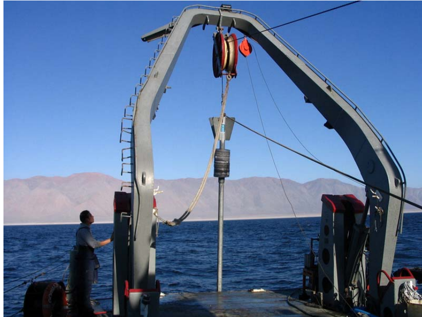
Figura 26. Corazonador puesto en la grúa oceanográfica, listo para ser arriado a la superficie del mar.
