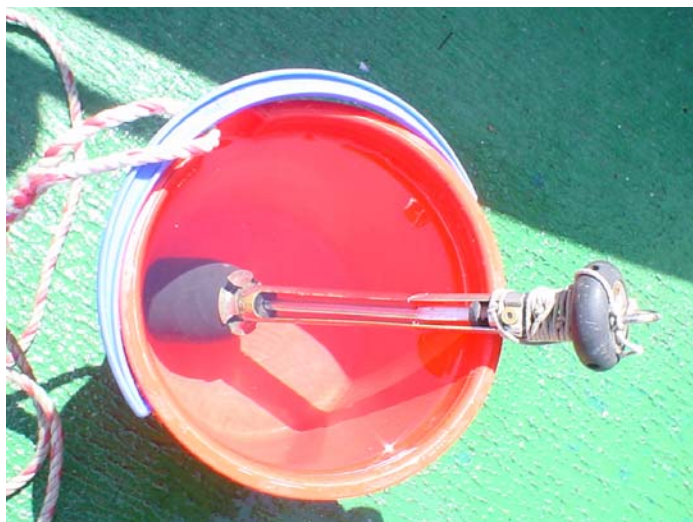
Figura 16. Termómetro de cazoleta registrando la temperatura superficial del mar.
