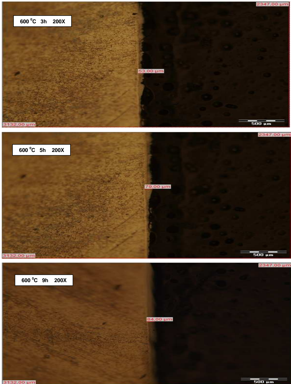
Figura 11. Microfotografía a 200X del acero ferrítico 9Cr-1Mo T91 en una mezcla alúmina-cloruro de amonio al 6%.
