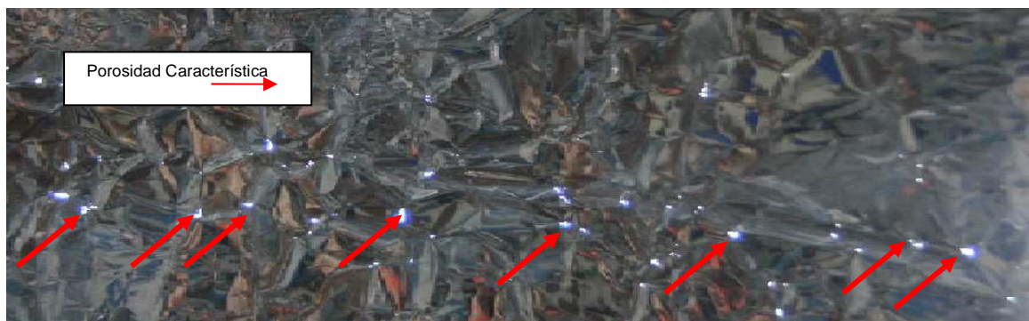
Figura 9. Oxidación y porosidad característica del papel aluminio.
