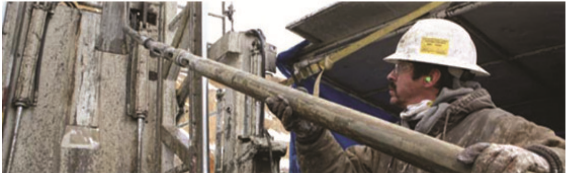
Figura 30. Traslado del barril interno
