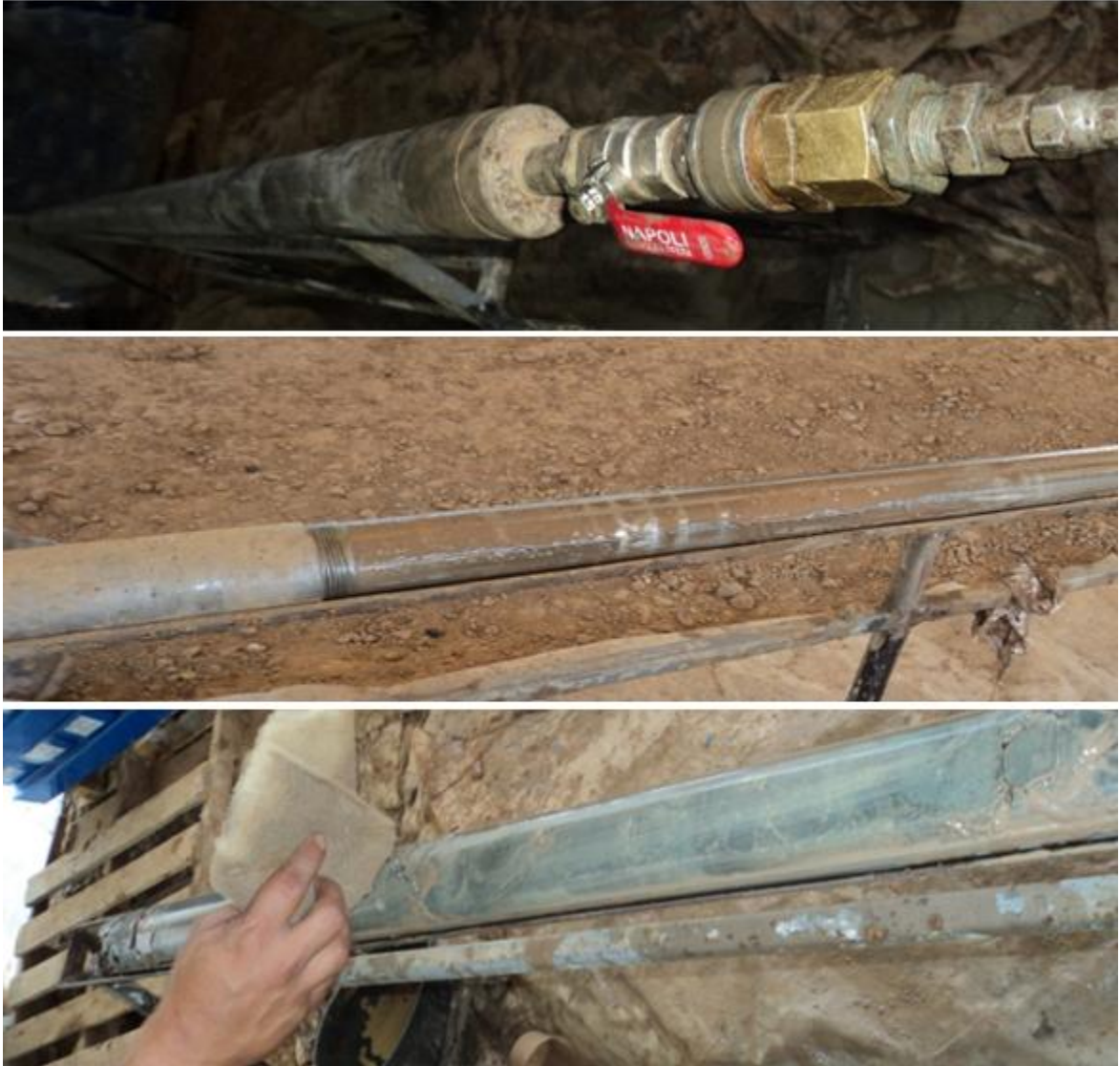
Figura 58. La extracción del núcleo del barril interno
