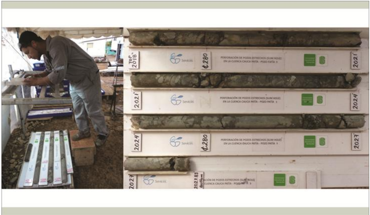
Figura 62. La toma fotográfica núcleo desnudo
