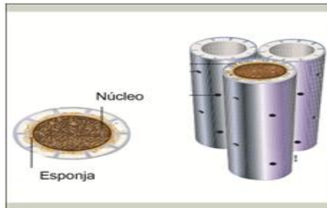
Figura 11. Corazonamiento de revestimiento con esponja
