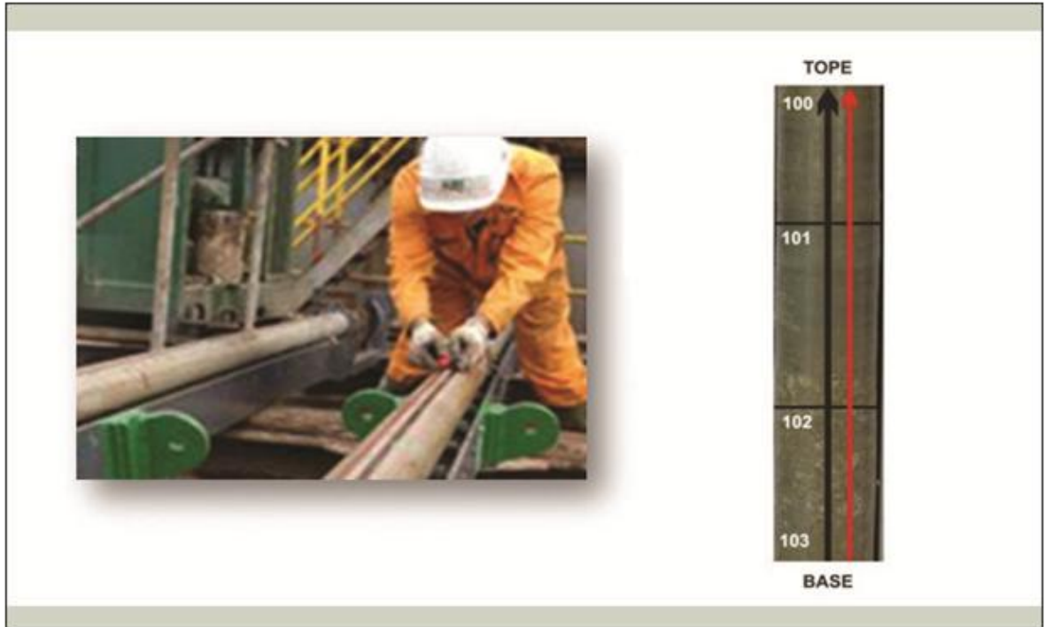
Figura 37. Marcado del núcleo desnudo
