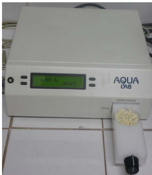
Figura D3. Analizador de la actividad de agua Aqualab modelo 3TE DECAGON.
