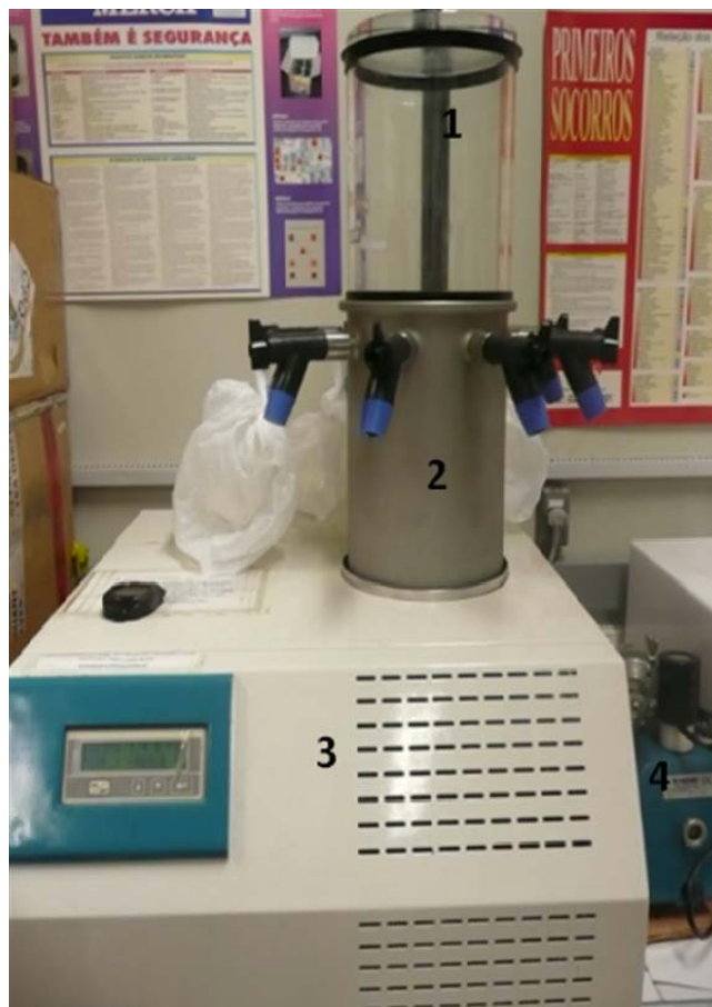
Figura D1. Liofilizador con sus partes principales.
