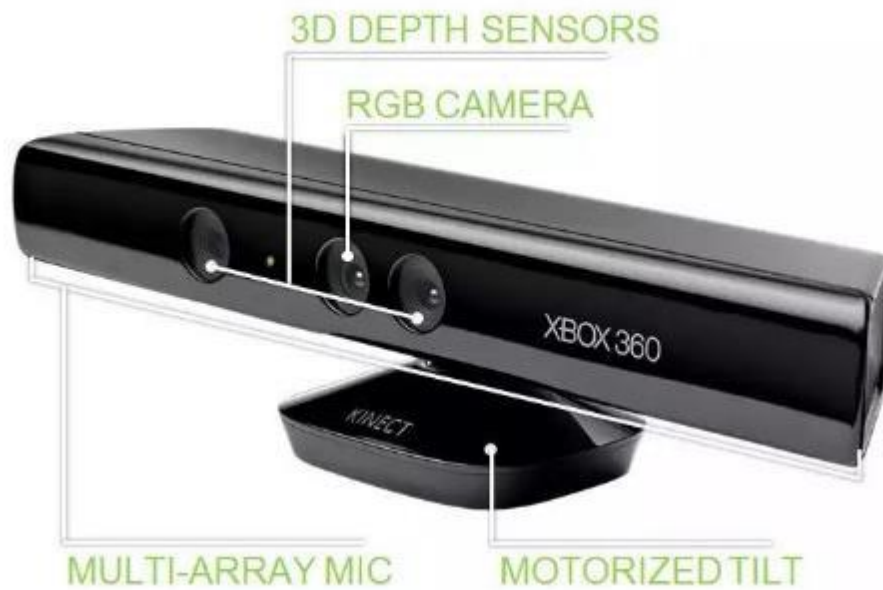
Figura 3: Partes que conforman el sensor Kinect
