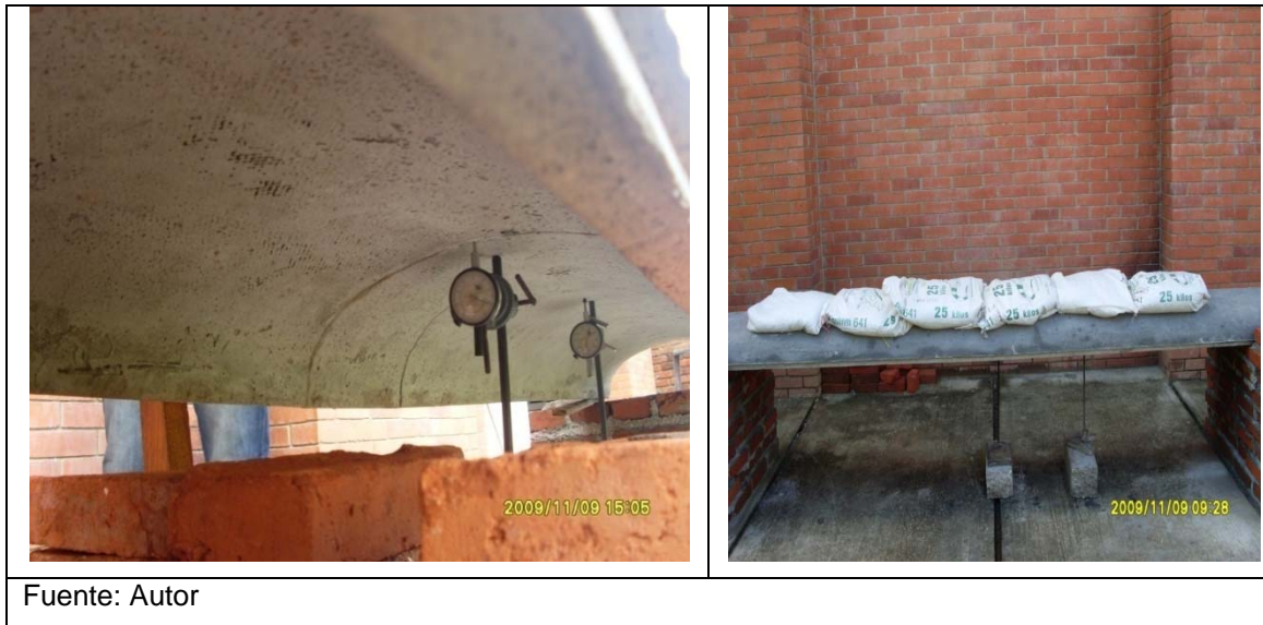
Fotografía 4.10. Posición de deformímetros.
