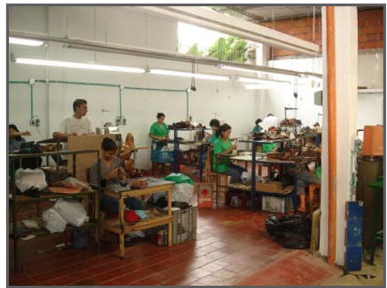
Proceso de Guarnición: Puestos de Trabajo distribuidos para iniciar el nuevo método de Celdas de manufactura
