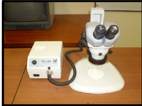
Figura 2. Lupa binocular NIKON N1-150, modelo C-PS, utilizada en la descripción macroscópica de las muestras. Laboratorio de lupas, Escuela de Geología, (UIS).
