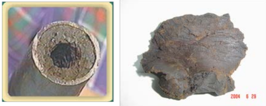
Figura 13. Evidencias de Precipitación de Parafinas en el Tubing, Campo Lisama.
