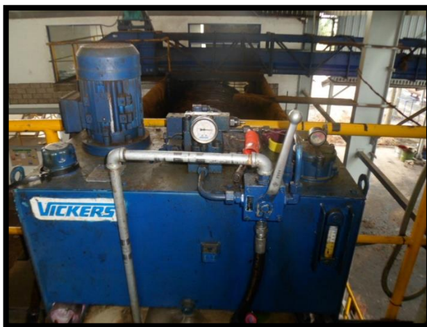
Figura 22. Sistema hidráulico de la prensa
