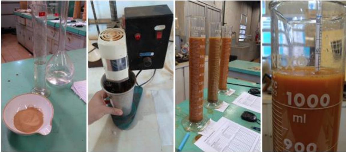
Figura 19. Procedimiento de sedimentación para determinar la granulometría de los suelos.
