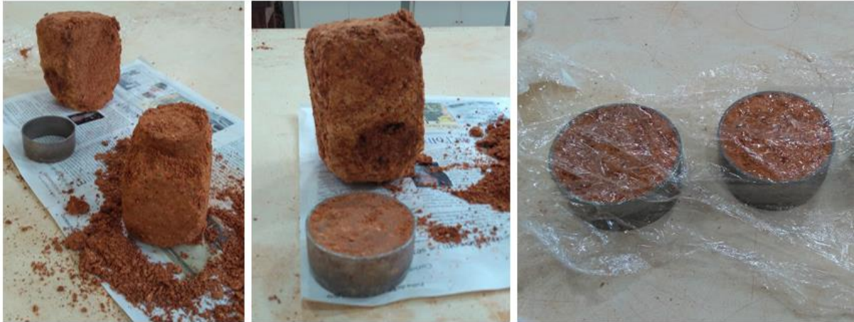
Figura 16. Procedimiento empleado para la preparación de muestras de suelo inalteradas.
