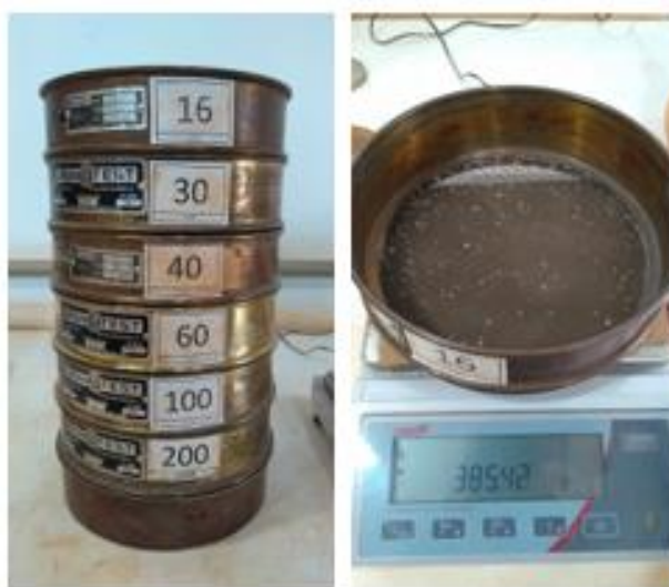
Figura 18. Procedimiento para determinar la granulometría de los suelos mediante tamizado.
