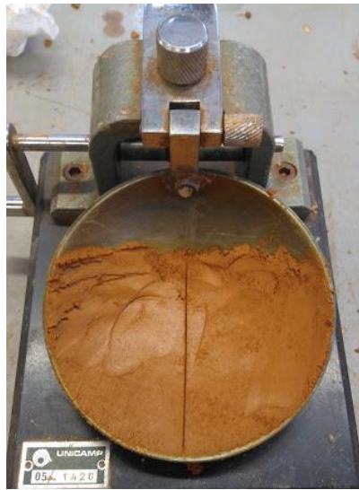
Figura 20. Aparato de Casagrande utilizado para determinar el límite líquido de los suelos.
