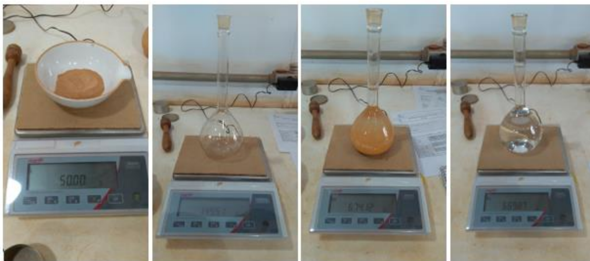
Figura 17. Procedimiento experimental para determinar el peso específico de los suelos.
