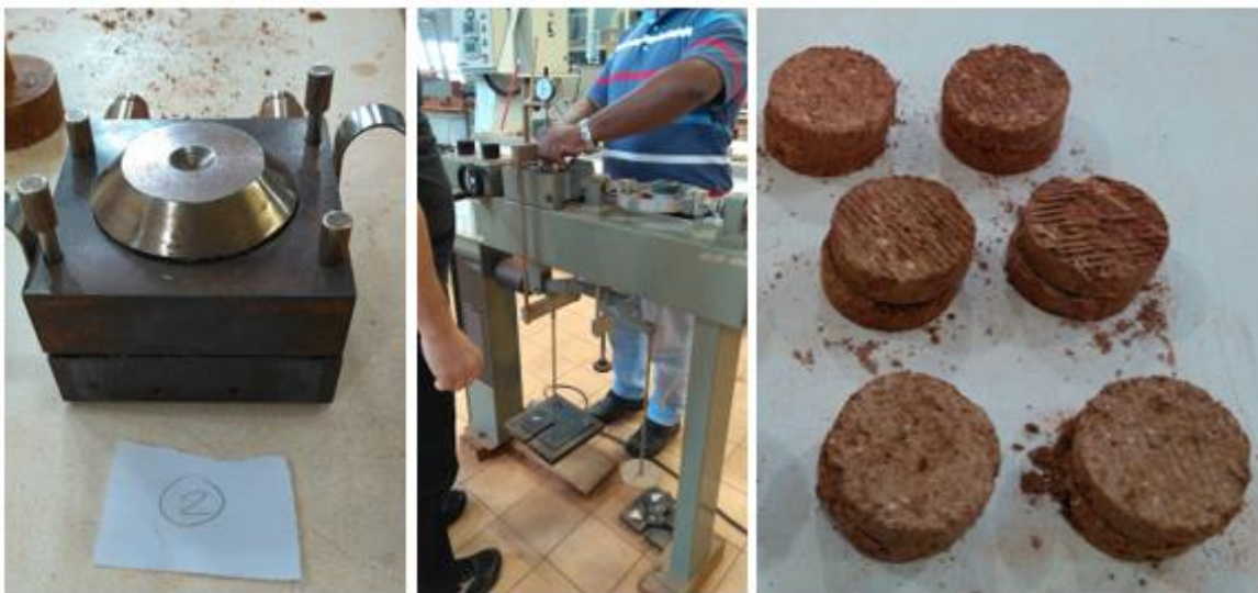
Figura 21. Procedimiento del ensayo de cizallamiento directo para determinar la resistencia al corte.
