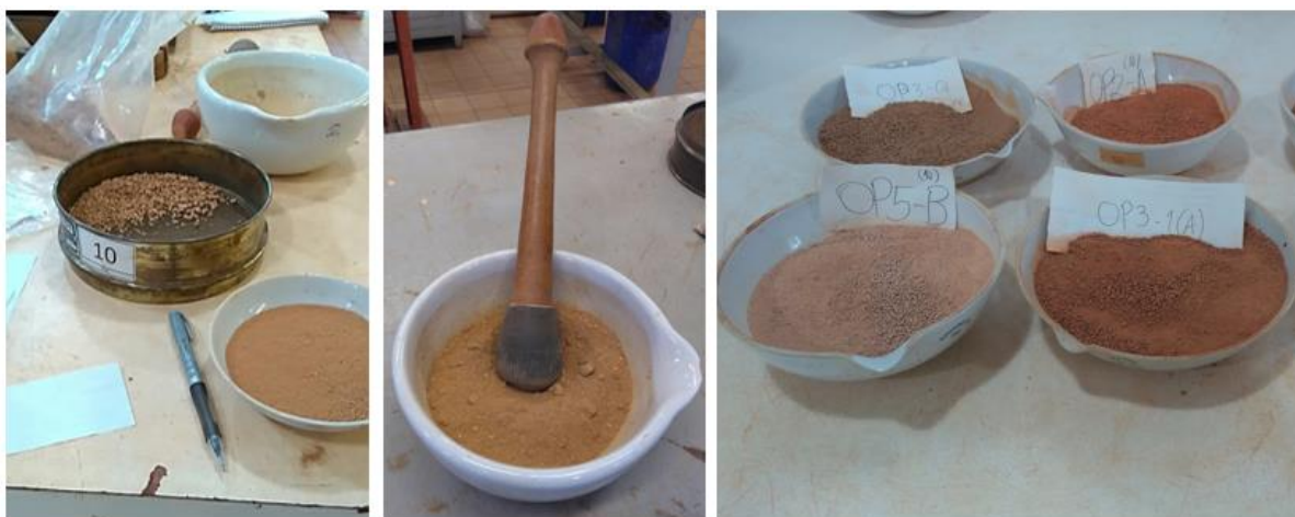
Figura 15. Procedimiento empleado para la preparación de muestras de suelo alteradas.
