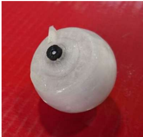
Fotografía 35. Piezas de prueba para el sistema de cierre, materiales y acabado.
