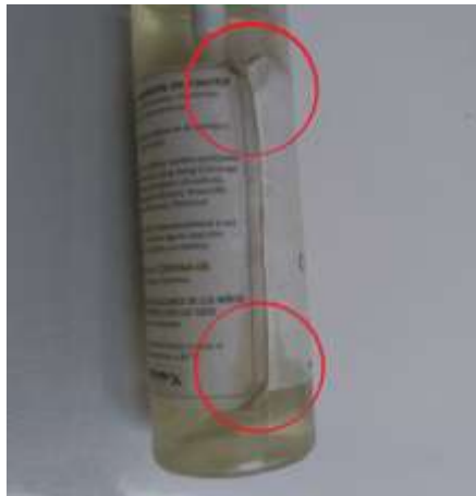
Fotografía 3. Deterioro de la etiqueta por contacto con el aceite
