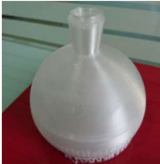
Fotografía 36. Cuerpo prototipado todavía sin los acabados.
