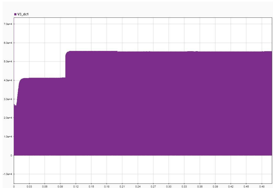
Figura 20. Tensión de salida del arreglo fotovoltaico sin filtro.
