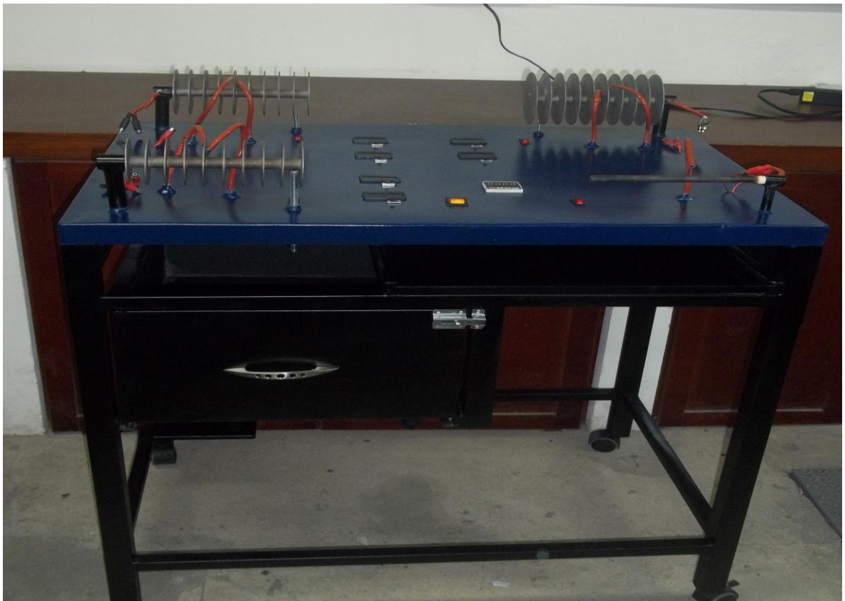
Figura 25. Banco de superficies extendidas.
