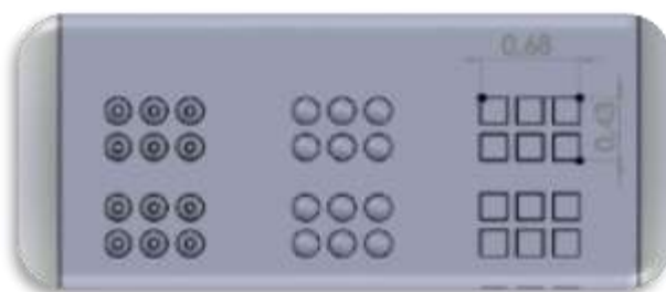
Figura 49: Medidas preliminares matriz Braille.
