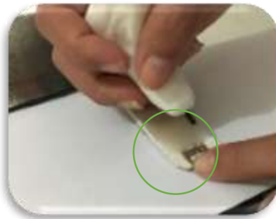
Figura 84: Accionamiento del riel con ayuda del dedo índice.
