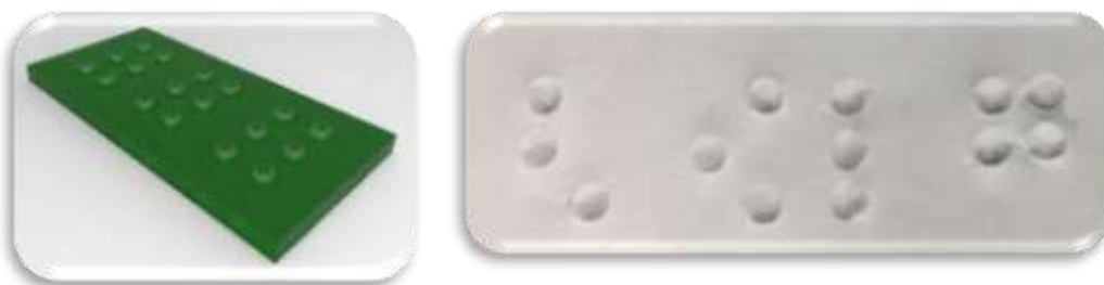
Resultado escritura forma cónica redondeada 0.5mm
