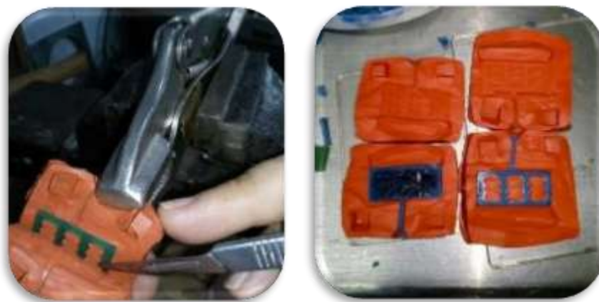
Figura 75: Obtención de moldes para fundición mediante cera perdida.
