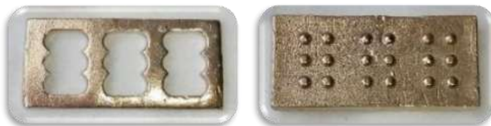
Figura 76: Resultado en bronce de la fundición. Autores
