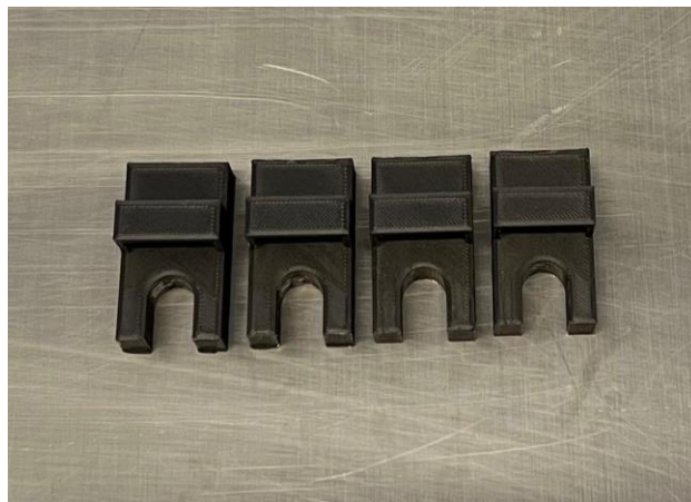
Figura 11. Soportes de PLA con fibra de carbono para accesorio de flexión a tres puntos.
