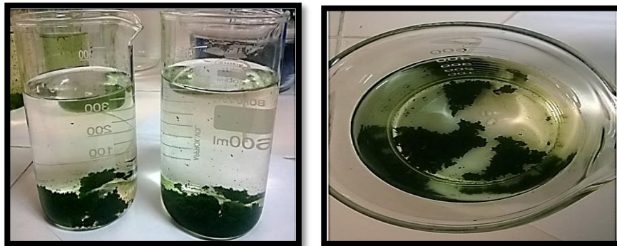
Figura 9. Alga obtenida con una concentración de floculante de 3.26 mg/L
