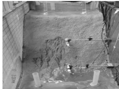
Figura 2. Configuración de los sensores para medir desplazamiento[2]
