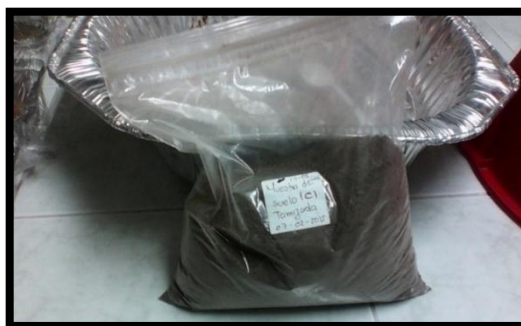
Figura 22. Muestra de suelo tamizada para ensayos de remediación.
