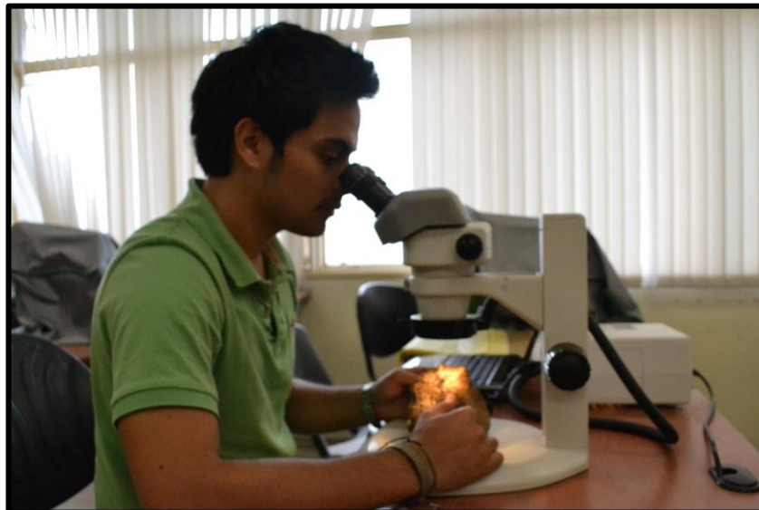
Figura 8. Lupa Nikon para análisis macro de las muestras de mano.
