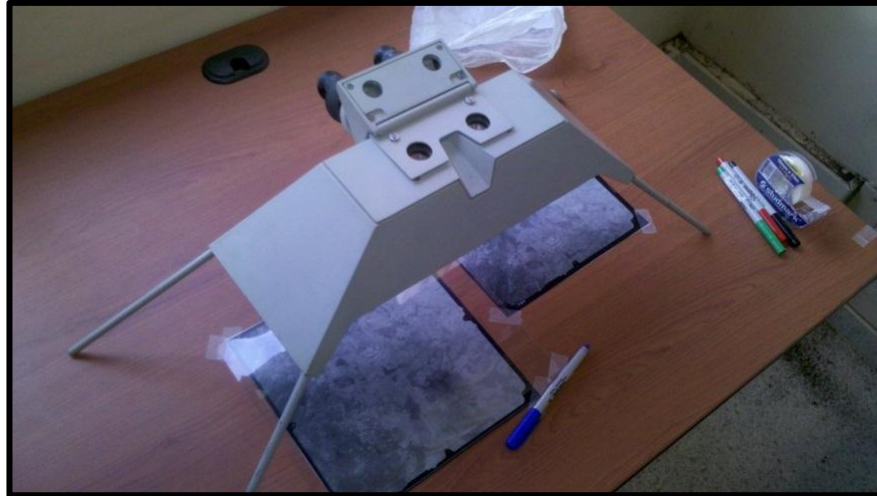
Figura 7. Estereoscopio de espejos utilizado en la fotointerpretación de imágenes aéreas.
