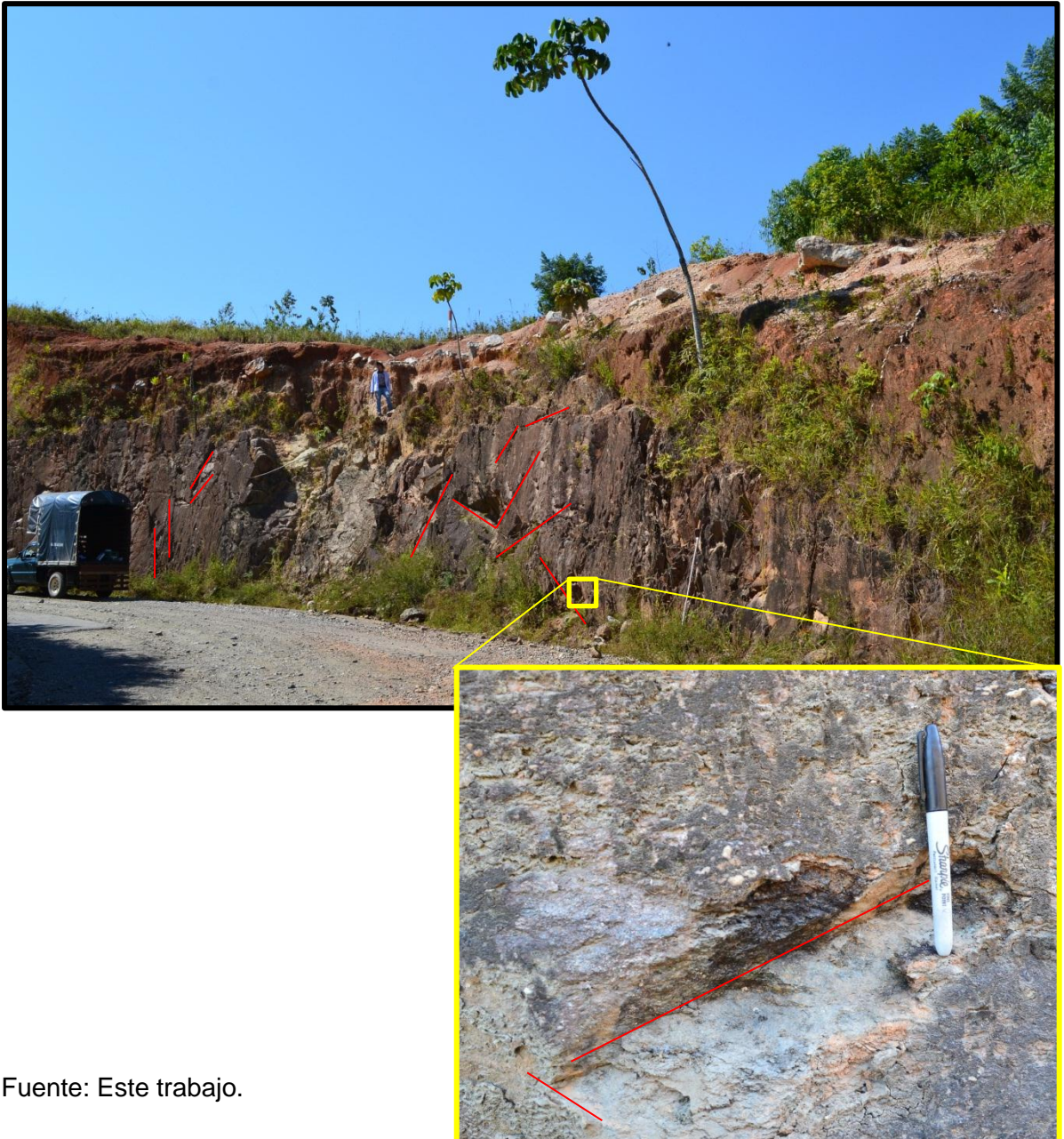
Figura 37. Afloramiento de rocas del basamento de la estación PAB-8, principalmente esquistos micáceos, zona de intenso diaclasamiento. La foto del afloramiento presenta una dirección en azimut de 4°.
