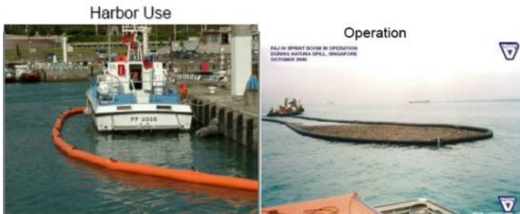
Figura 66. Separadores tipo barco con flotadores. Propiedad de International spill control organization 2007 ©
