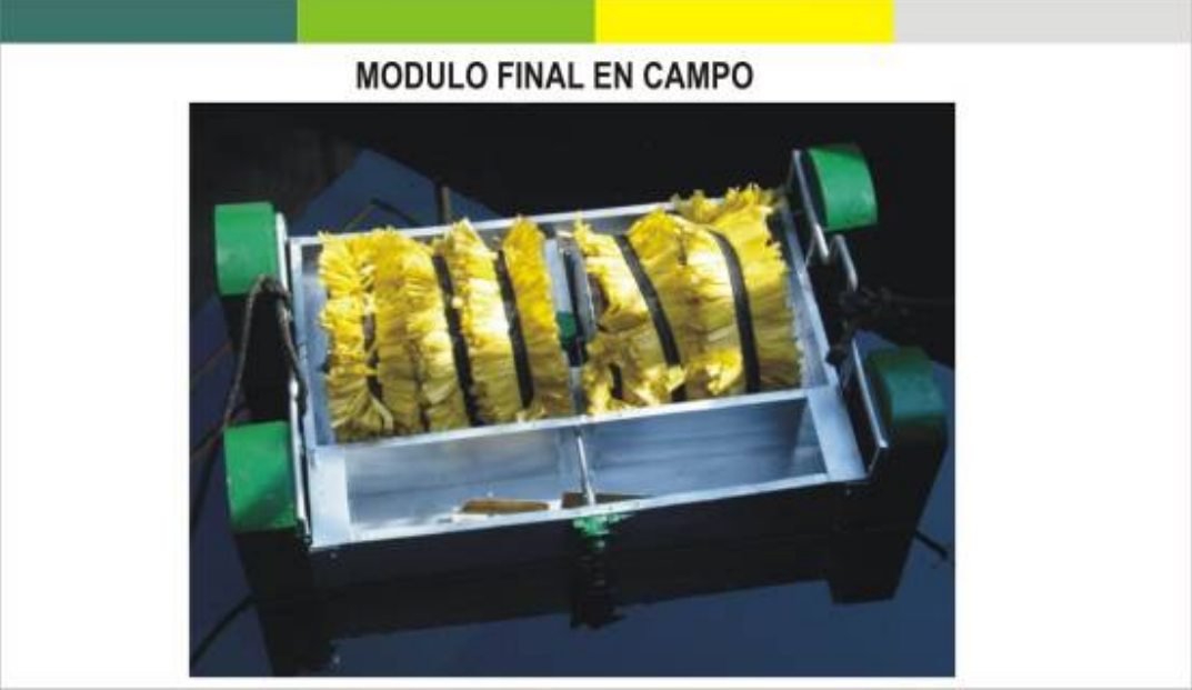
Figura 170. Modulo final separador de hidrocarburo
