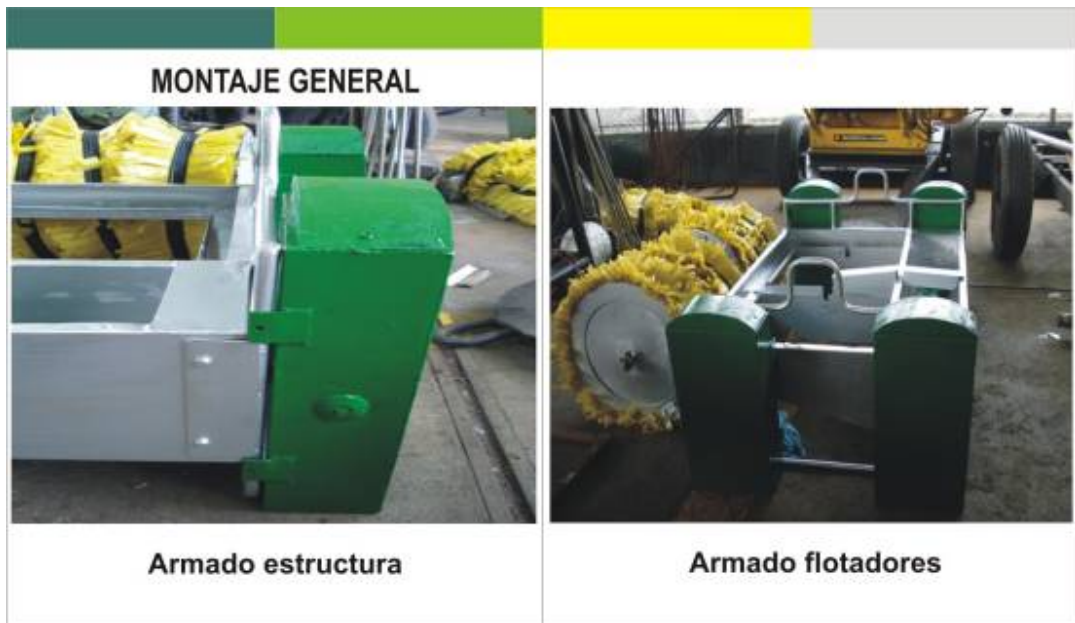
Figura159. Armado estructura de la tolva y flotadores
