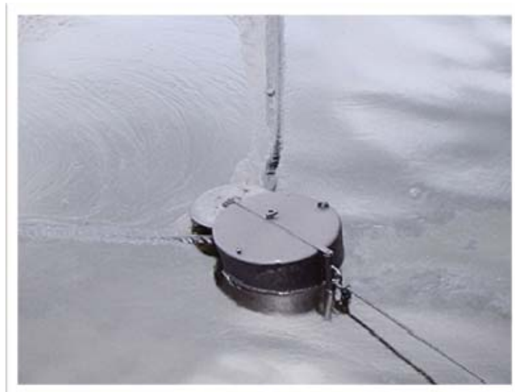
Figura 38. Disco en material lamina de acero tensionada a la pared
