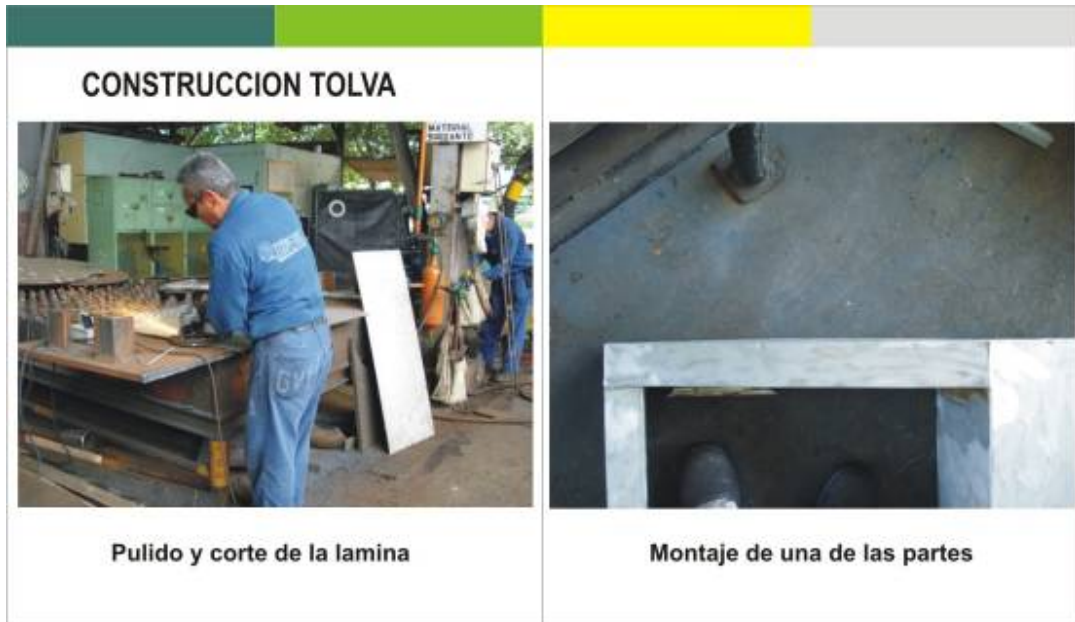
Figura145. Pulido y corte de la lamina para la tolva
