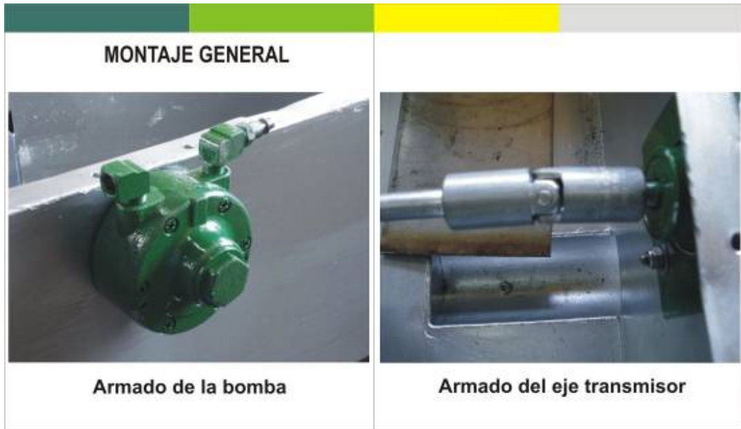
Figura 160. Armado sistema hidráulico
