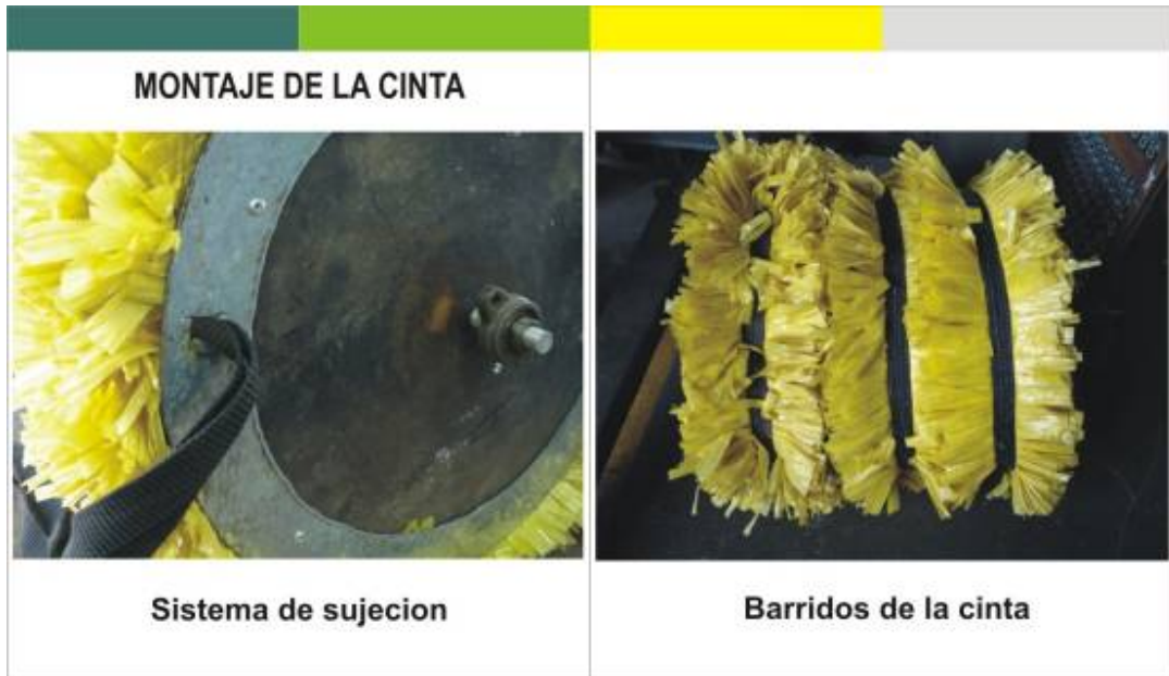
Figura 162. Armado de la cinta
