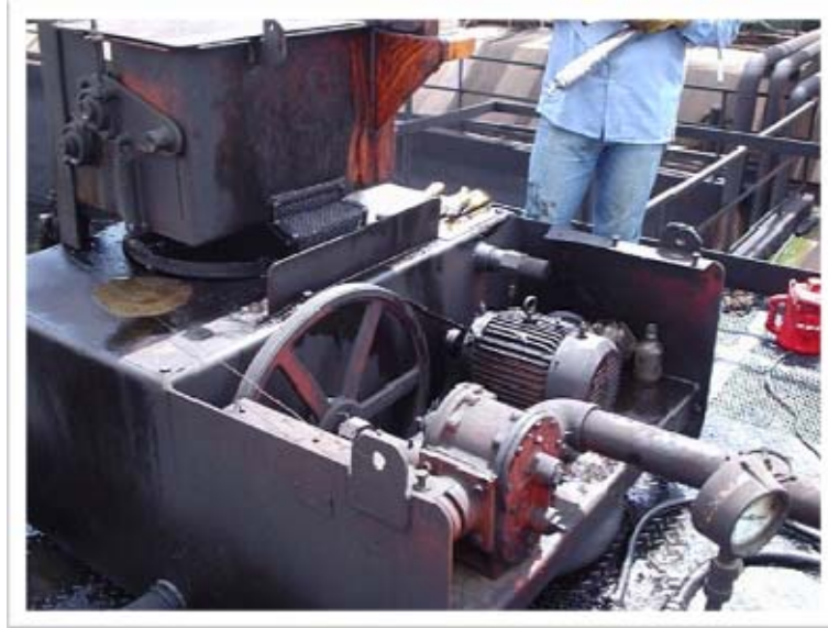
Figura 39. La piscina de recibo consta de una bomba y un motor
