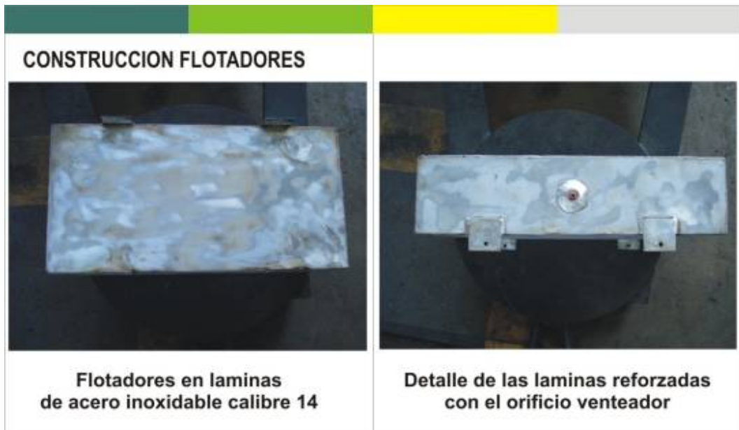
Figura147. Detalle del refuerzo de los flotadores
