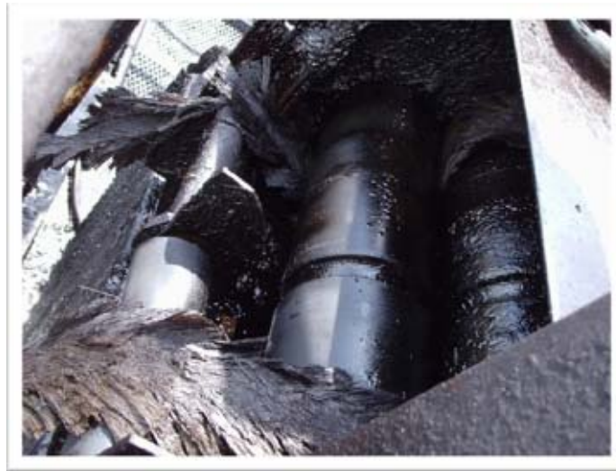
Figura 37. Discos que exprimen la cinta oleofílica
