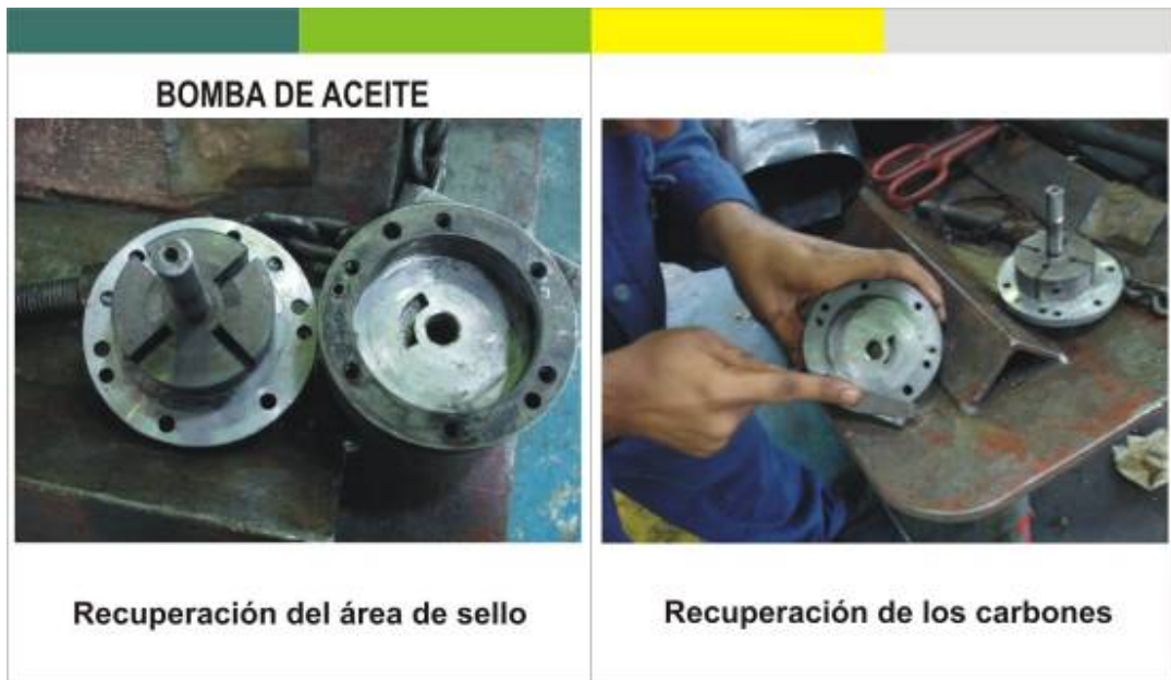
Figura151. Recuperación de la bomba de aceite
