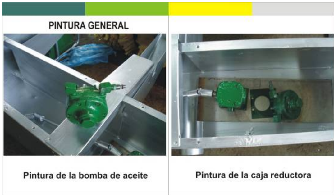
Figura157. Pintura sistema hidráulico
