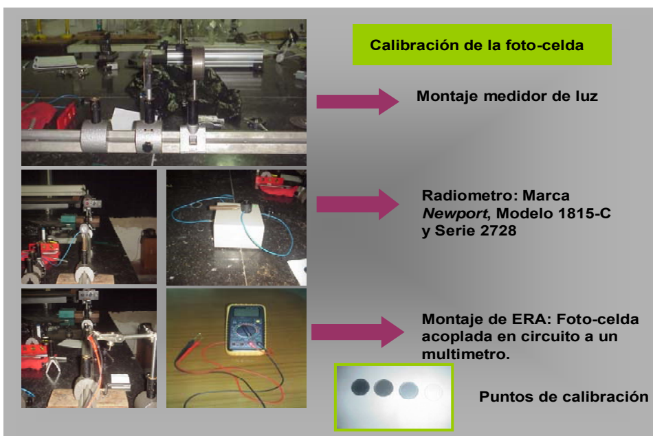
Figura 34. Esquema general del procedimiento realizado para la calibración de la foto-resistencia (Laboratorio de Óptica y Tratamiento de Señales, UIS).
