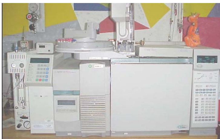
Figura 35. Cromatógrafo de gases Agilent Technologies 6890 Plus , y un detector selectivo de masas (MSD) Agilent Technologies 5973 Network .
