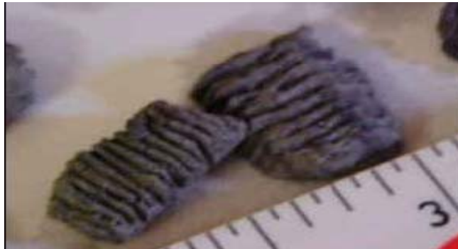
Figura 22. Cortes de perforación usando el sistema Performadril™
