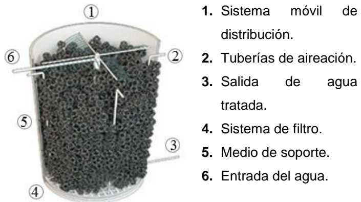
Figura 2. Representación Filtro Percolador
