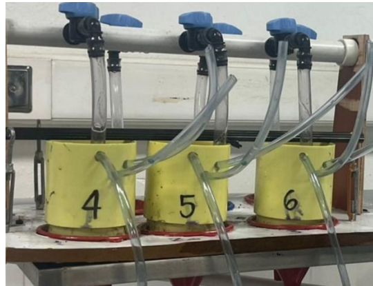
Figura 6. Orificios para sistema de desagüe del permeámetro.
