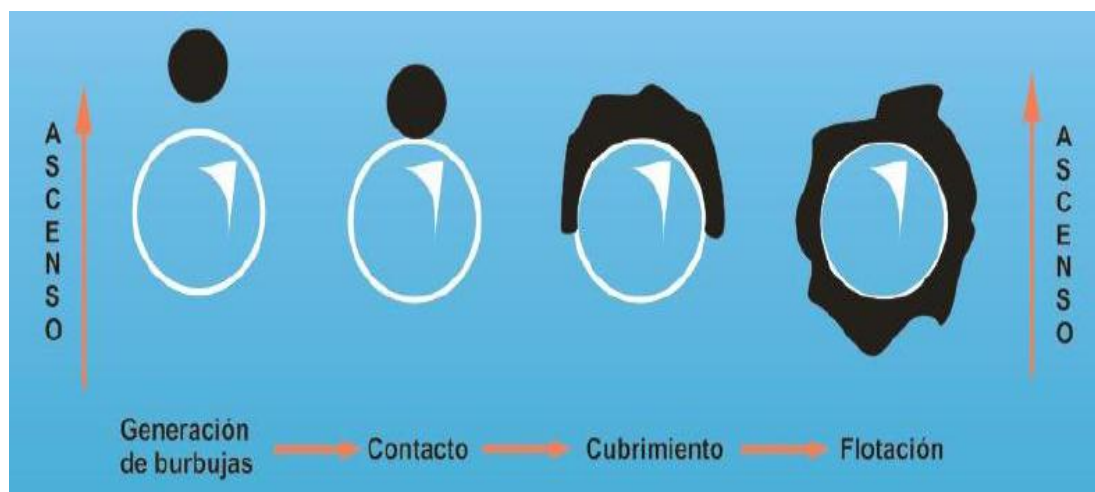
Figura 46. Etapas básicas de un proceso de Flotación.
